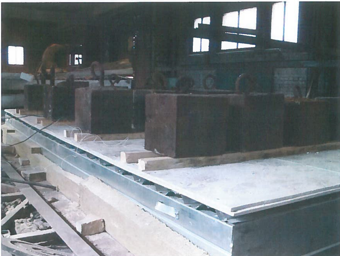
Рис. 2. Опытный образец № 1 с приложенной равномерно-распределенной нагрузкой
