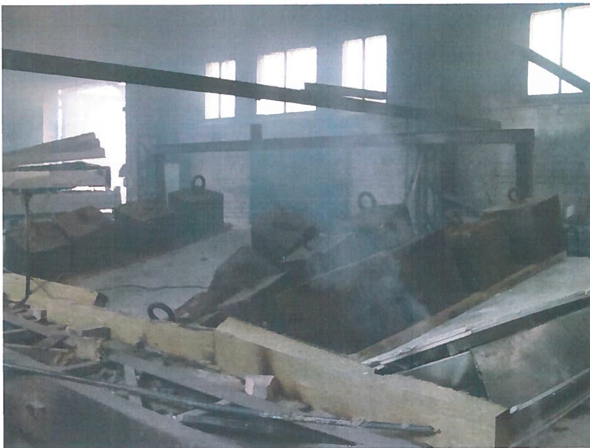
Рис. 4. 95 мин испытания, достижение опытным образцом № 2 предельного состояния по потере несущей способности (R), вследствие обрушения конструкции
