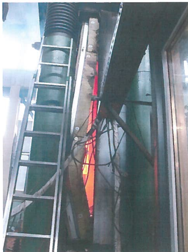
Рис. 4. 95 мин испытания, достижение опытным образцом № 2 предельного состояния по потере несущей способности конструкции (R), вследствие возникновения предельной вертикальной деформации.
