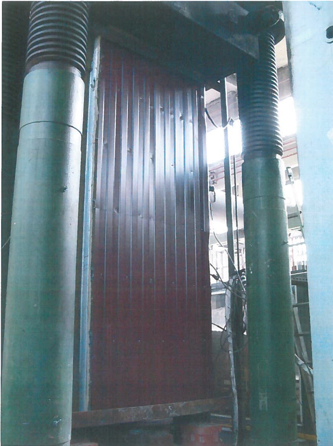
Рис. 2. Опытный образец № 1 конструкции наружной несущей стеновой панели, Подготовленный к испытанию на огнестойкость
