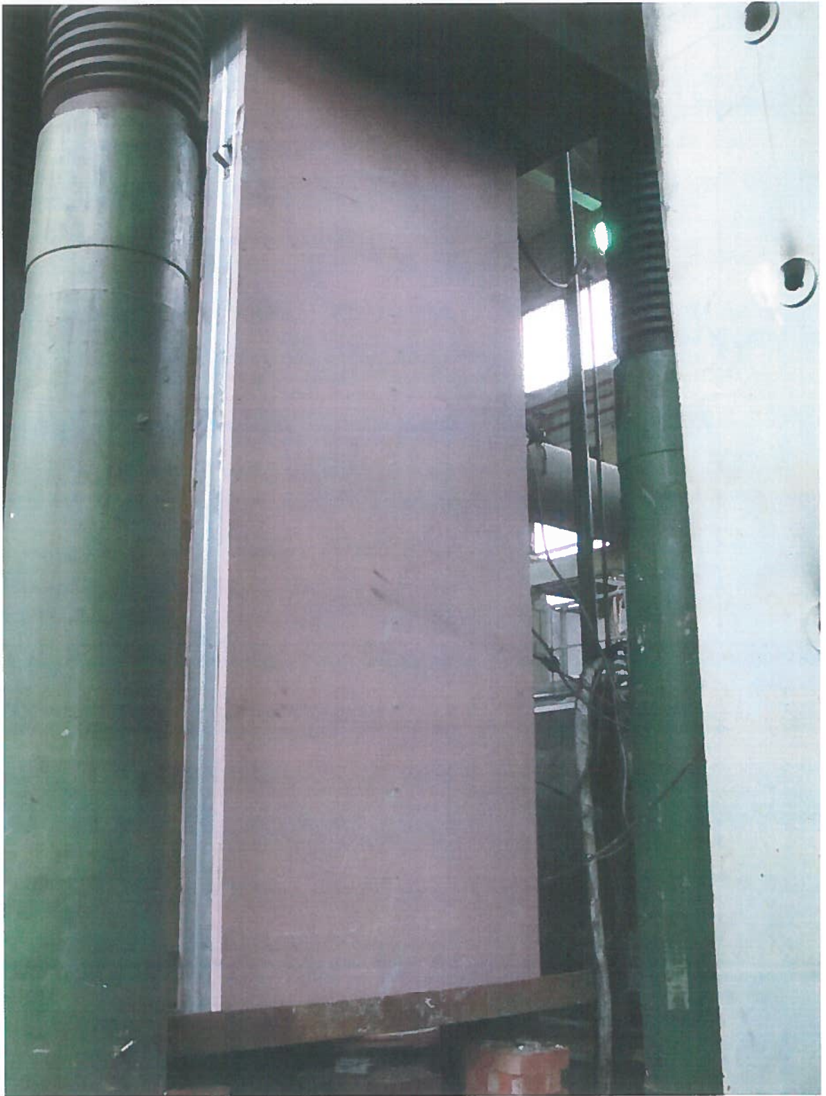
Рис. 2. Опытный образец № 1 конструкции внутренней несущей стеновой панели, подготовленный к испытанию на огнестойкость
