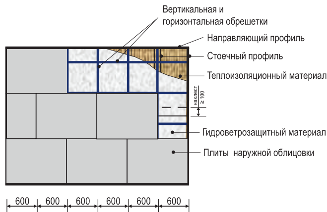
Рис. 13. Крепление наружной облицовки к каркасу
